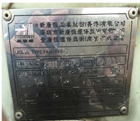
碱性废气处理风机铭牌
